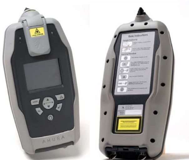
Obr. 2 Mobilní Ramanův spektrometr Ahura First Defender – pohled z vrchu a ze spodu
